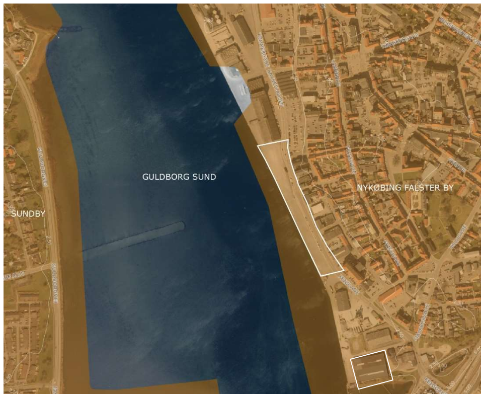
Figur 7-2: Højdekurver og geomorfologi. Planområdet (hvid) er beliggende i et bundmoræne landskab (brun). Havneområdet ligger i kote 2,5 hvor landskabet stiger til kote 7,5 i Nykøbing Falster by.
