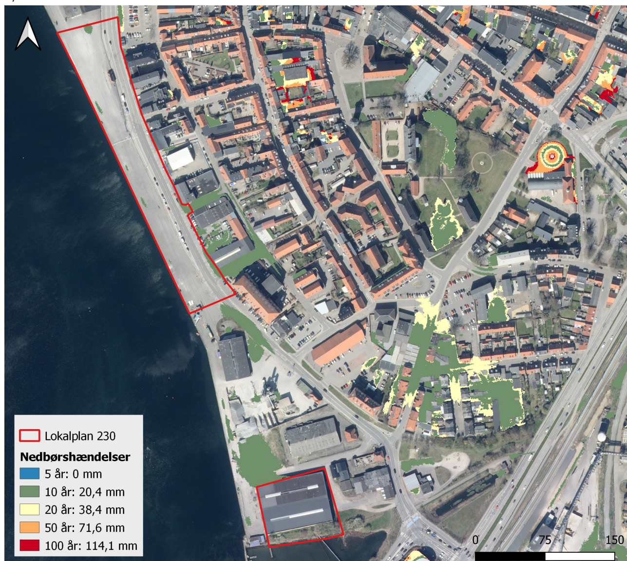
Kortlægning af påvirkningen på havnen og de havnenære arealer ved mulige nedbørshændelser (Ill.: Guldborgsund Kommune).
